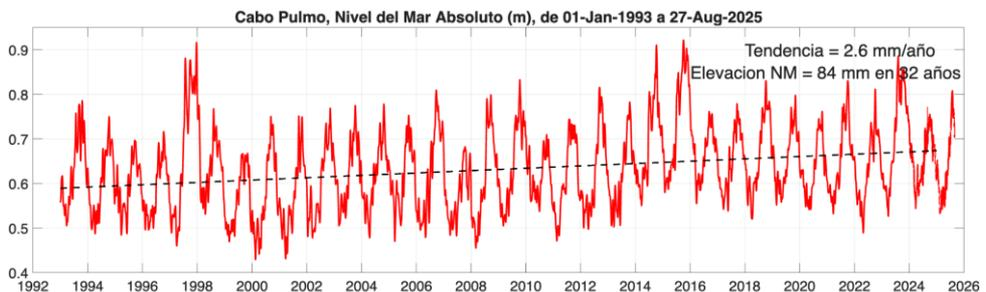
**Figura 2.3:** Nivel del mar absoluto (m) en Cabo Pulmo, BCS. Inicia en enero de 1993 y termina en agosto de 2025. Incluye el nivel del mar con referencia al geode y la tendencia de largo período debida al calentamiento global. Este sitio representa la variabilidad de la entrada al Golfo de California.
