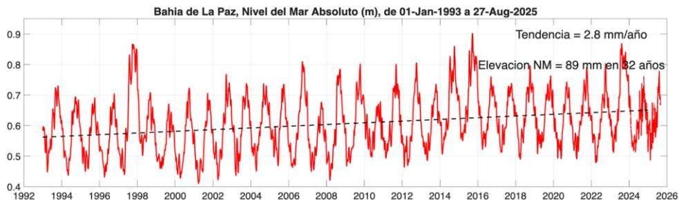
**Figura 2.4:** Nivel del mar absoluto (m) en la bahía de La Paz, BCS. Inicia en enero de 1993 y termina en agosto de 2025. Incluye el nivel del mar con referencia al geoido y la tendencia de largo período debida al calentamiento global.
