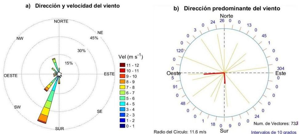
**Figura 7.2:** Velocidad y dirección (16 direcciones) del viento registradas durante el período de verano (junio-julio), 2025 en la bahía de La Paz graficados como: a) Rosa del viento (dirección y velocidad) y b) vectores del viento que indica la frecuencia y el número de vectores calculados (cada 10 grados). Los vectores en rojo indican los ejes principales promedio de la máxima y mínima varianza del viento registrado durante el período analizado.
