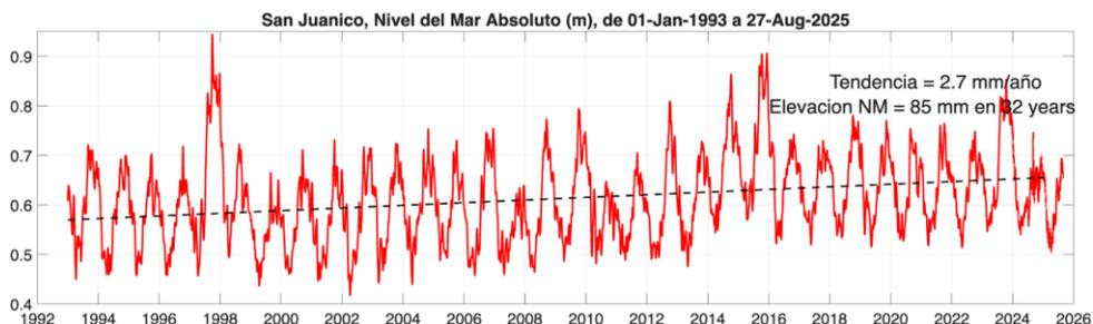
**Figura 2.5:** Nivel del mar absoluto (m) en la San Juanico, BCS, costa pacífico norte de BCS. Inicia en enero de 1993 y termina en agosto de 2025. Incluye el nivel del mar con referencia al geode y la tendencia de largo período debida al calentamiento global. Este sitio representa la variabilidad del Golfo de Ulloa.
