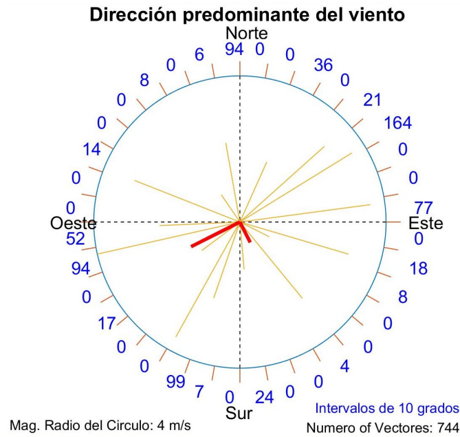
Figura 18: Dirección predominante del viento durante el período del 01 de diciembre, 2023 al 31 de enero del 2024, mostrada en forma de rosa de vectores los registros de la Estación meteorológica La Paz (c/2hrs). El círculo indica el número de vectores calculados (744 registros) y su dirección predominante (cuadrantes). Los vectores en rojo indican los ejes principales promedio de la máxima y mínima varianza del viento promedio.
